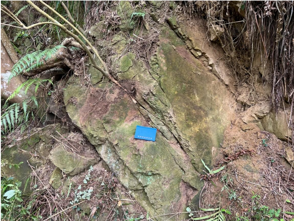
圖 24 黃棕色中粒砂岩露頭照片。砂岩風化嚴重，含多組裂隙，岩體完整性較差，攝於照片點 2。
