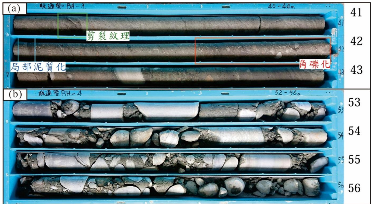
圖 31 BH04 鑽井岩心照片與石門斷層帶判釋。(a)BH04 鑽井深度 40~43 公尺處，有明顯角礫化、密集剪裂紋理以及細粒泥質物，推論為石門斷層經過之範圍。(b)BH04 鑽井深度 53~56 公尺處之礫石沉積單元，可以透過照片觀察以灰白色礫石為主，形狀圓至次圓狀，淘選度差，膠結狀況不好，推論為河川之沉積物。
