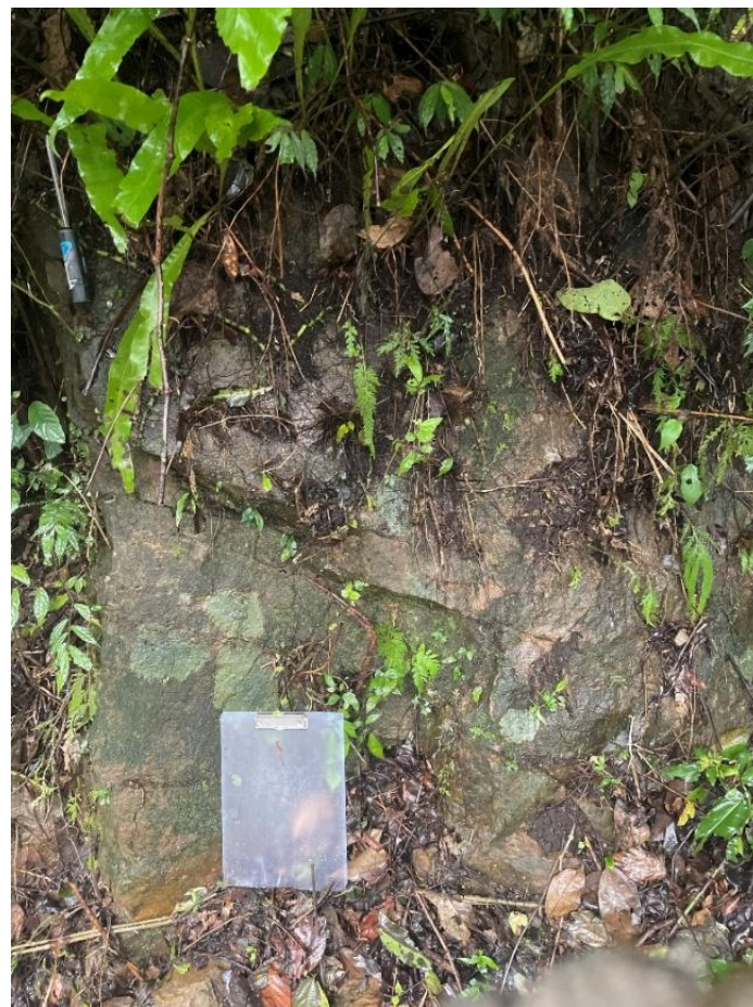
圖 28 照片點 5 之塊狀青灰色砂岩露頭照片。砂岩質地較緻密，岩體呈塊狀。
