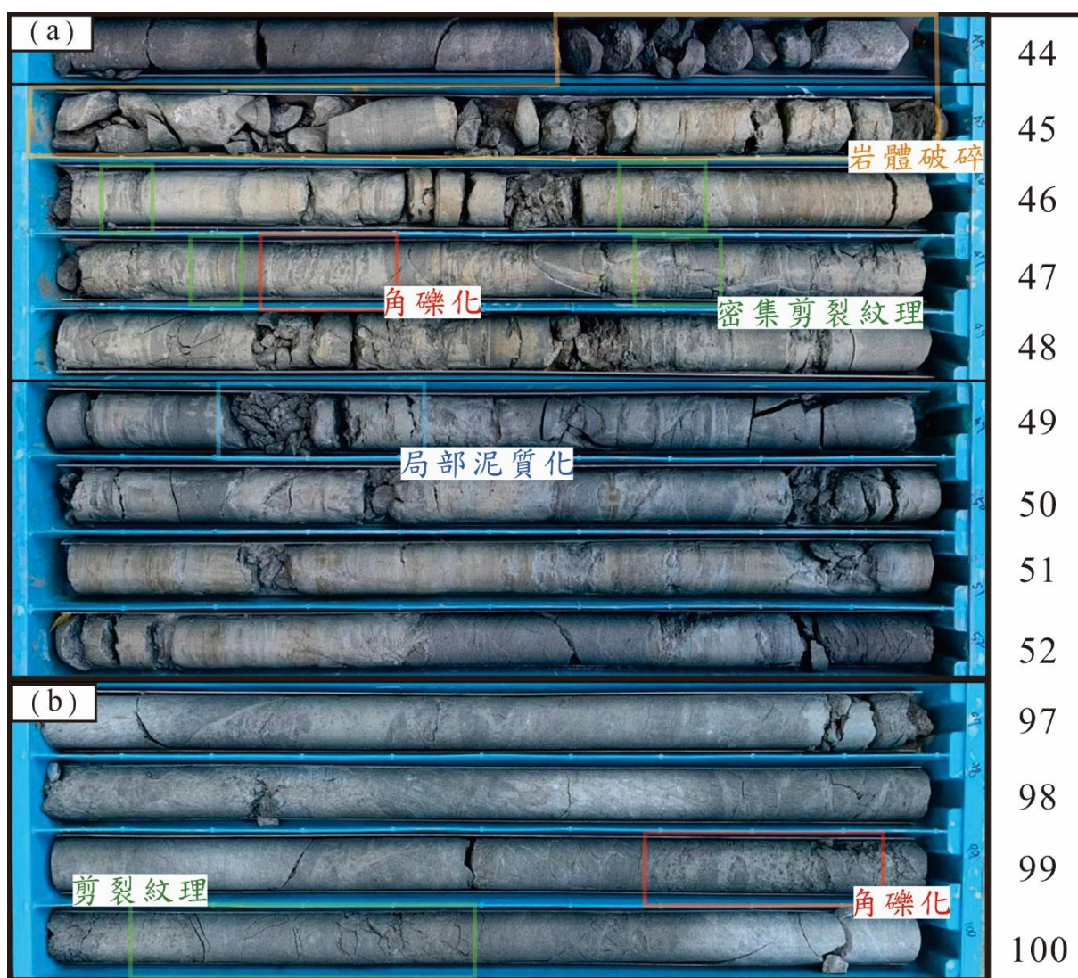
圖 32 DH08 鑽井岩心照片與石門斷層帶判釋。(a)DH08 鑽井深度 43~52 公尺處，有明顯角礫化、岩體破碎、密集剪裂紋理以及斷層泥之區段，推論為石門斷層的斷層核心。(b)DH08 鑽井深度 96~100 公尺處，為石門斷層下盤發現之角礫化以及細粒泥質基質之區段，但因其破碎不明顯，變形特徵較上部(a)分散，故推論其為石門斷層之下盤分支毀壞帶。
